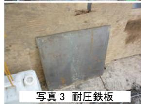
写真3 耐圧鉄板
